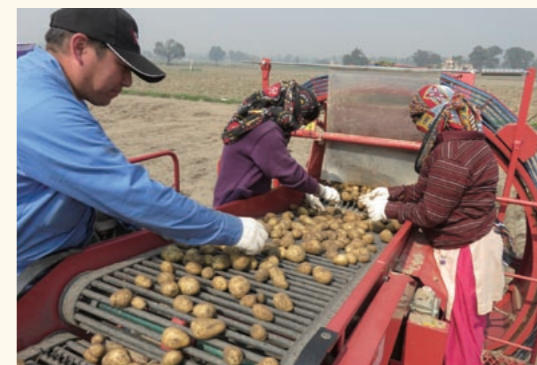
機上の選別コンベヤー。少ない人員でジャガイモを容易に選別できる
