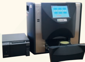
一瞬で成分を分析できるカワサキ機工の茶成分分析計。お茶のおいしさを科学の目で判断する
